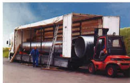
Das Bild zeigt die **MSL**-Gesellschafter im Frühsommer 2003 vor 2 doppelwandigen Segmentbogen 90°, innen aus Edelstahl, außen aus verzinktem Material. Der Innendurchmesser der Rohre und Formteile beträgt 1400 mm, der Außendurchmesser 1475 mm.
