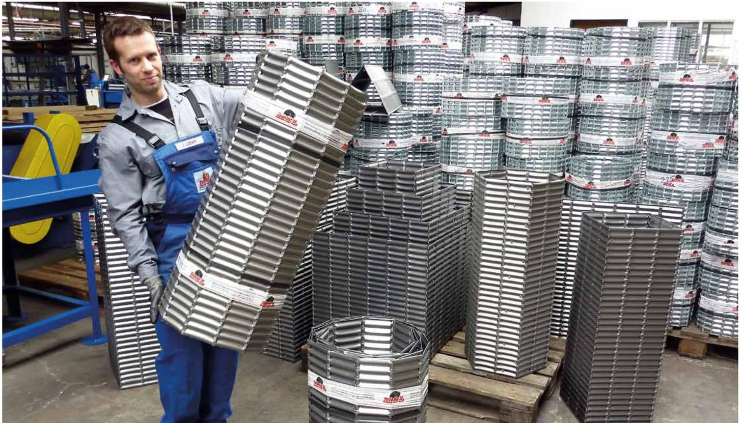
Das **MSL**- Aussparungssystem Vario wird in Breiten von 130 mm bis 890 mm als Rollenware mit 6 m Schalungslänge angeboten.
